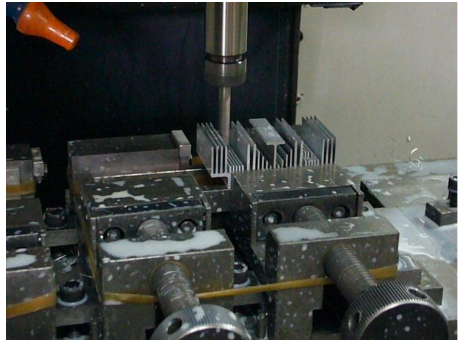
CNC 刀具向下，實際加工銑 圓孔徑
