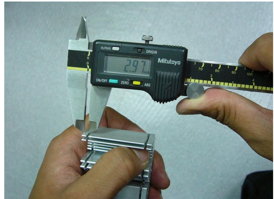
使用游標卡尺檢測剖溝後之尺寸是否合格
